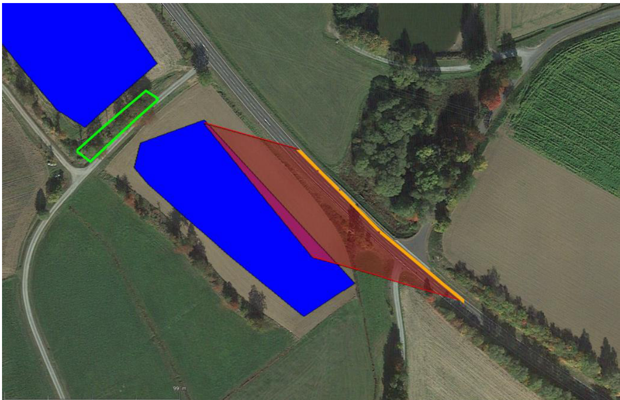
Abbildung 14: Betroffener Streckenabschnitt in Orange, relevante Reflexionen von PV-Feld-2 in Rot, bestehende Gehölze/Bäume in Grün (Quelle: Google Earth)
