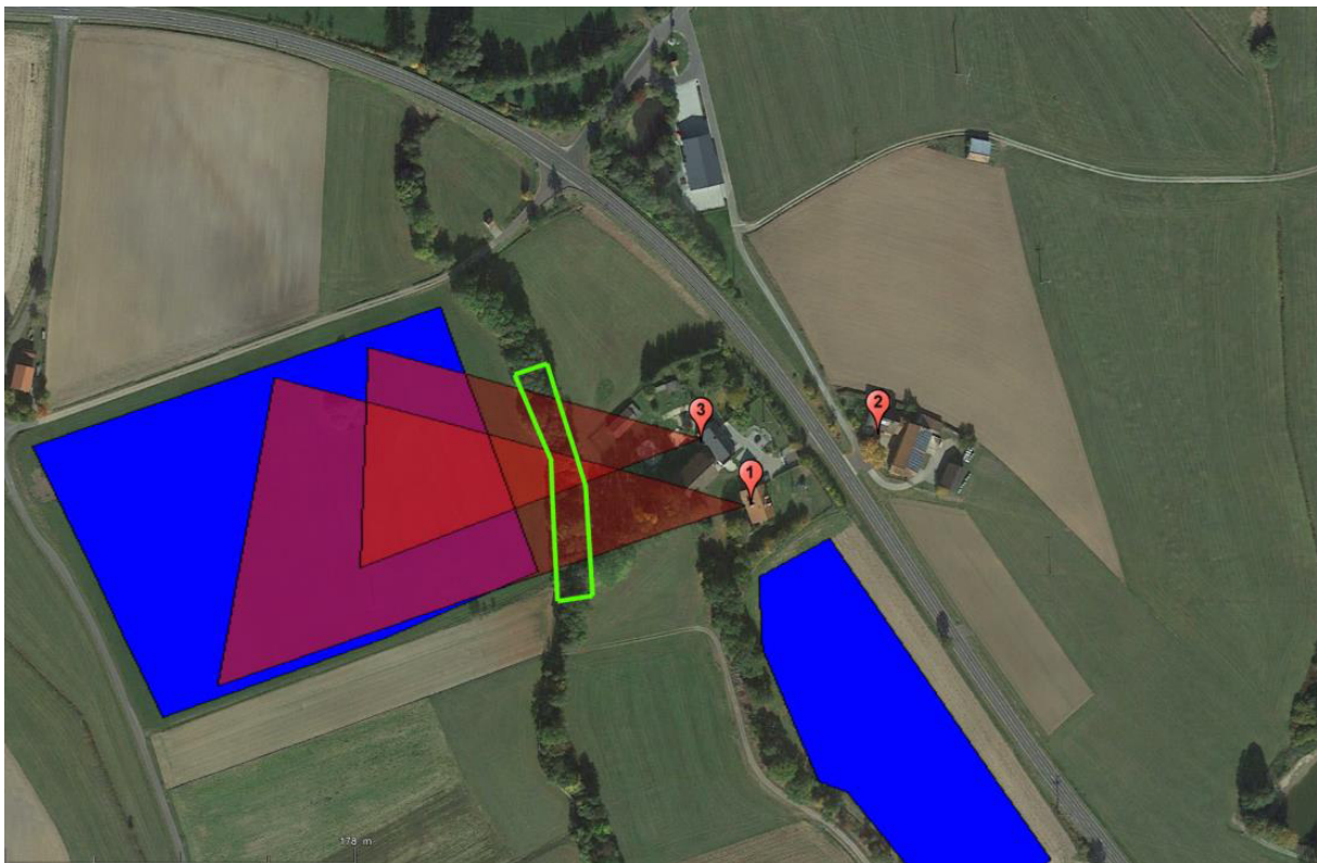
Abbildung 17: Von potenzieller Blendung betroffenes Sichtfeld der Wohnbebauungen gemäß Simulation in Rot, bestehender Gehölzstreifen grün markiert (Quelle: Airbus, Maxar Technologies, Google Earth)
